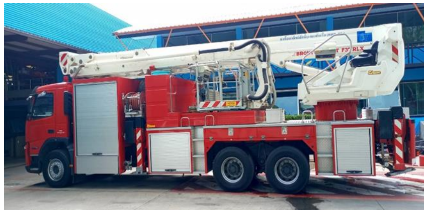
รถดับเพลิงอาคารสูง ชนิดหอน้ำสูง ๓๗ เมตร สมอ ๔๗๖๑๕ ความจุถังน้ำ ๒,๐๐๐ ลิตร จุโฟม ๑,๐๐๐ ลิตร
